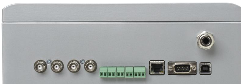
Alarm wire inputs
